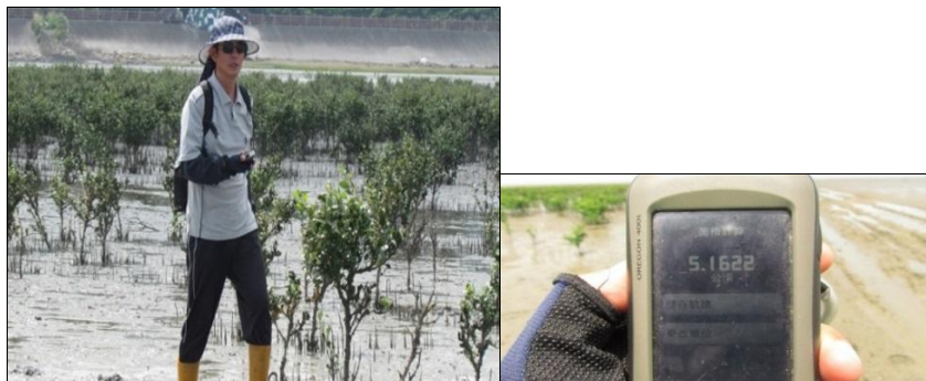
圖六：GPS 循跡測量圖七：GPS 面積測量計算清除範圍 5.16 公頃
